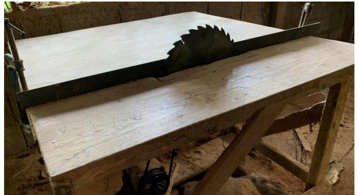
เครื่องเลื่อยวงเดือน ที่นักเรียนใช้มาตลอด ๓๐ ปี จัดหาขึ้นส่วนและมาประกอบกันเอง
