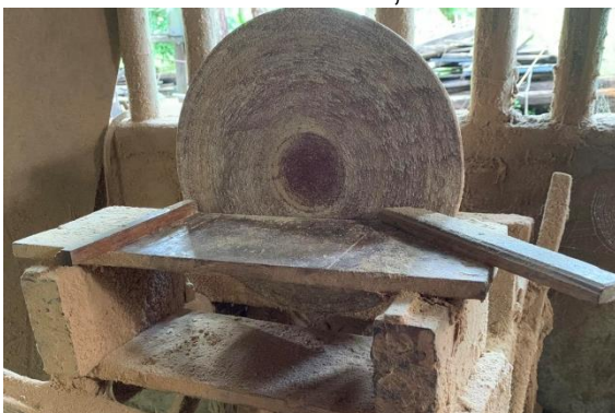
เครื่องขัดกระดาษทราย ที่ซื้อชิ้นส่วนมาประกอบเอง การปรับองศาเพื่อขัดเข้ามุม ใช้เศษไม้ประกอบเป็นองศาเข้าไม้
